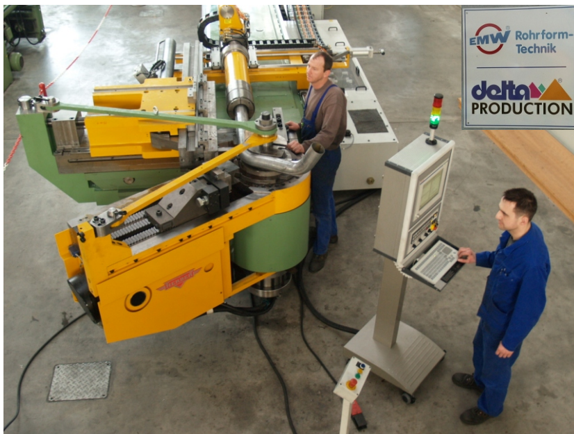
• Rohrbiegemaschine Herber CNC 150 im Einsatz bei EMW Rohrformtechnik
